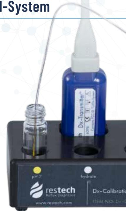
Das innovative Diagnostik-System „RESTECH Dx-pH“ ermöglicht erstmals bei Verdacht auf Laryngo-Pharyngealen Reflux (LPR) eine Messung der Säurebelastung am Ort der Symptome.
